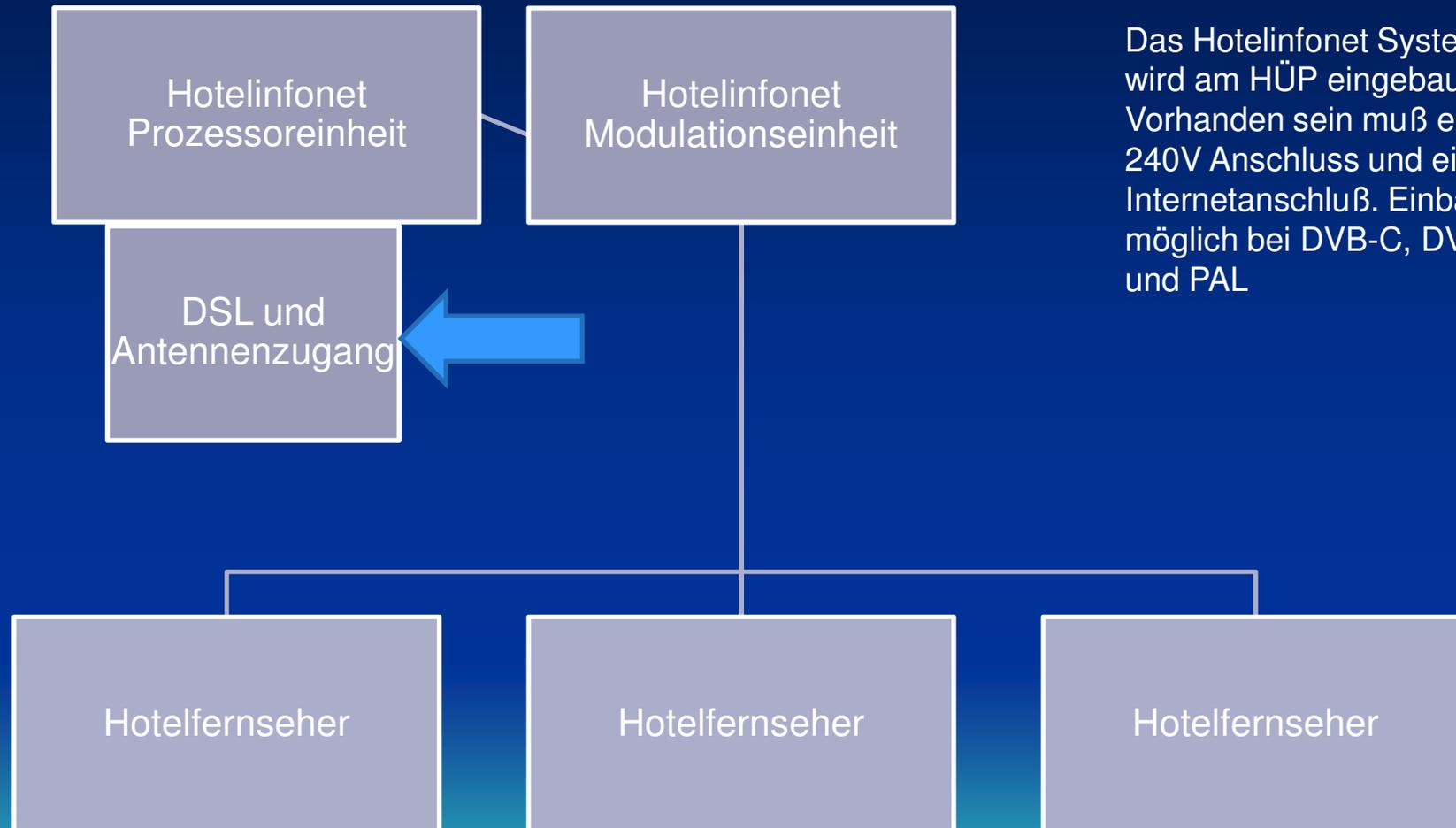
Das Hotelfononet System wird am HÜP eingebaut. Vorhanden sein muß ein 240V Anschluss und ein Internetanschluß. Einbau möglich bei DVB-C, DVB-T und PAL
